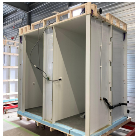
6. De eerste productie voor Gouwzee; de eerste prefab badkamer. Deze staat in de fabriek myCUBY; één van onze samenwerkingspartners.
