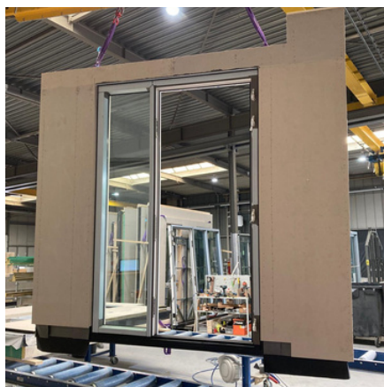
8. Eerste prefab gevel in de fabriek van Webo.
